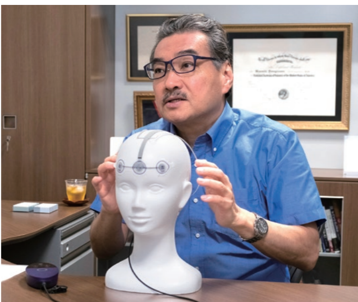
「S,UIMIN」が開発した脳波測定装置。臨床レベルの脳波による睡眠計測が自宅で簡単にできる
